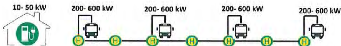
Figura 5.3. Încărcarea în stații intermediare, pe traseu.
