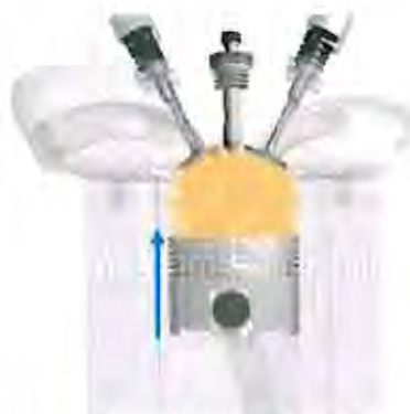
Figura 4.9. Comprimarea la motoarele Diesel (Sursa: Learn Engineering).
