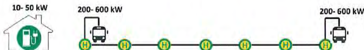
Figura 5.4. Încărcarea la capăt de linie.
