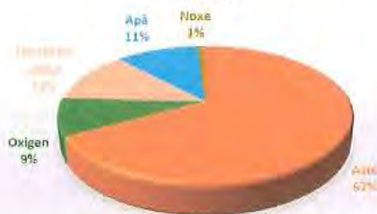
Figura 4.12. Compoziția gazelor rezultate din arderea motorinei.
