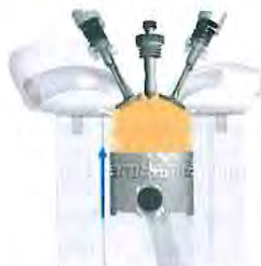
Figura 4.9. Comprimarea la motoarele Diesel (Sursa: Learn Engineering).
