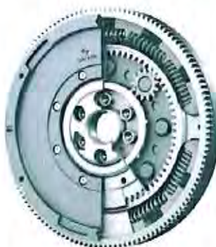
Figura 4.6. Volantul motor (Sursa: http://www.scoalarutiera.ro ).
