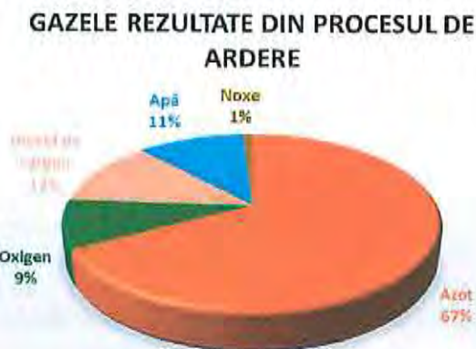
Figura 4.12. Compoziția gazelor rezultate din arderea motorinei.
