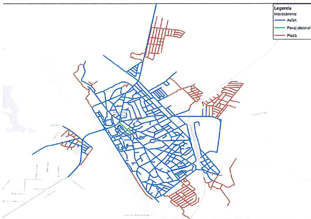
Figura 3.19. Distribuția străzilor în funcție de tipul îmbrăcăminții. Sursa: PMUD ZUF Râmnicu Sărat.
