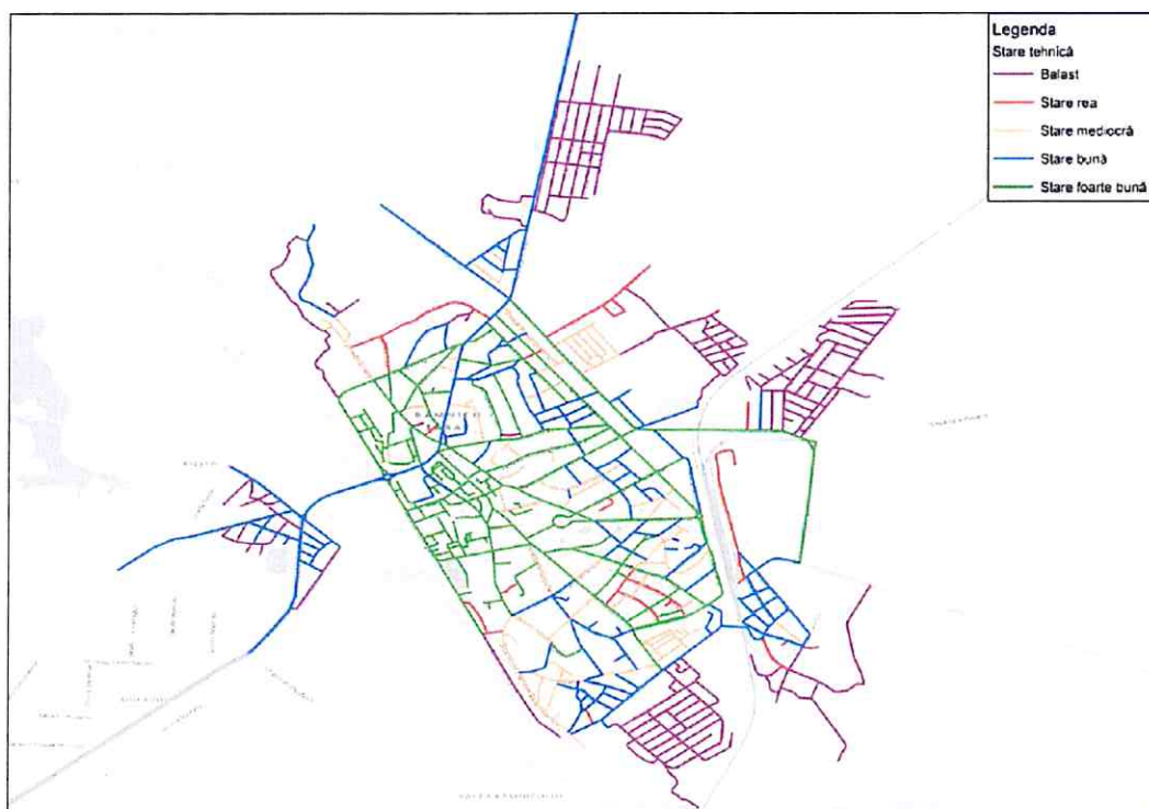
Figura 3.20. Distribuția străzilor în funcție de starea tehnică. Sursa: PMUD ZUF Râmnicu Sărat.
