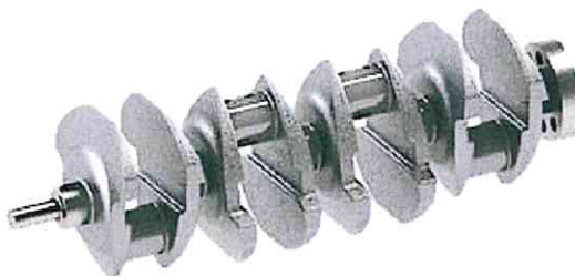
Figura 4.4. Arborele cotit (Sursa: http://www.scoalarutiera.ro ).
