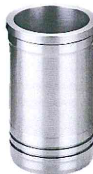
Figura 4.5. Cilindru motor (Sursa: http://www.scoalarutiera.ro ).
