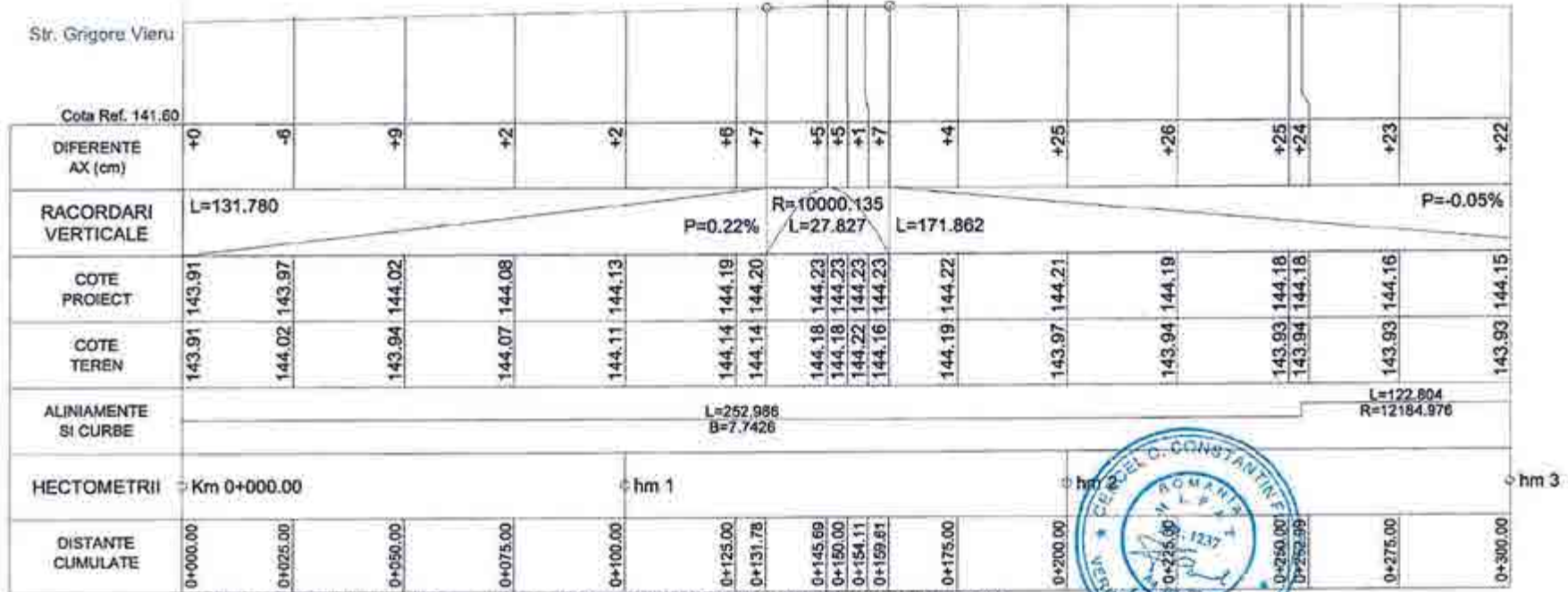
PROFIL LONGITUDINAL Str. Dunarii DE LA 0.000 LA 300.000 SCARA : ORIZ 1 :1000 VERT 1 :100
