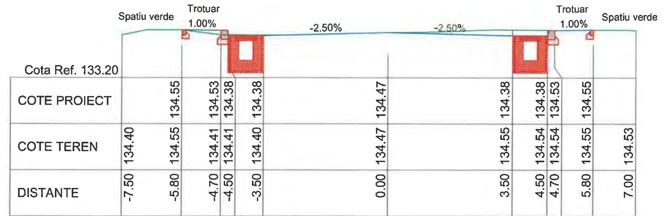
Pz. KM 276.00 STRADA BUZAU LUI
