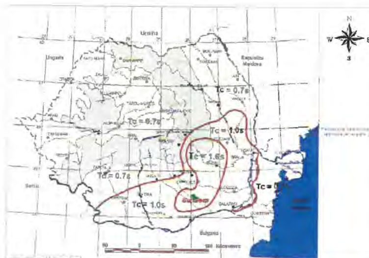
Zonarea teritoriului României în termeni de perioadă de control (colț), T_c a spectrului de răspuns. Codul de proiectare P100-1/2013
