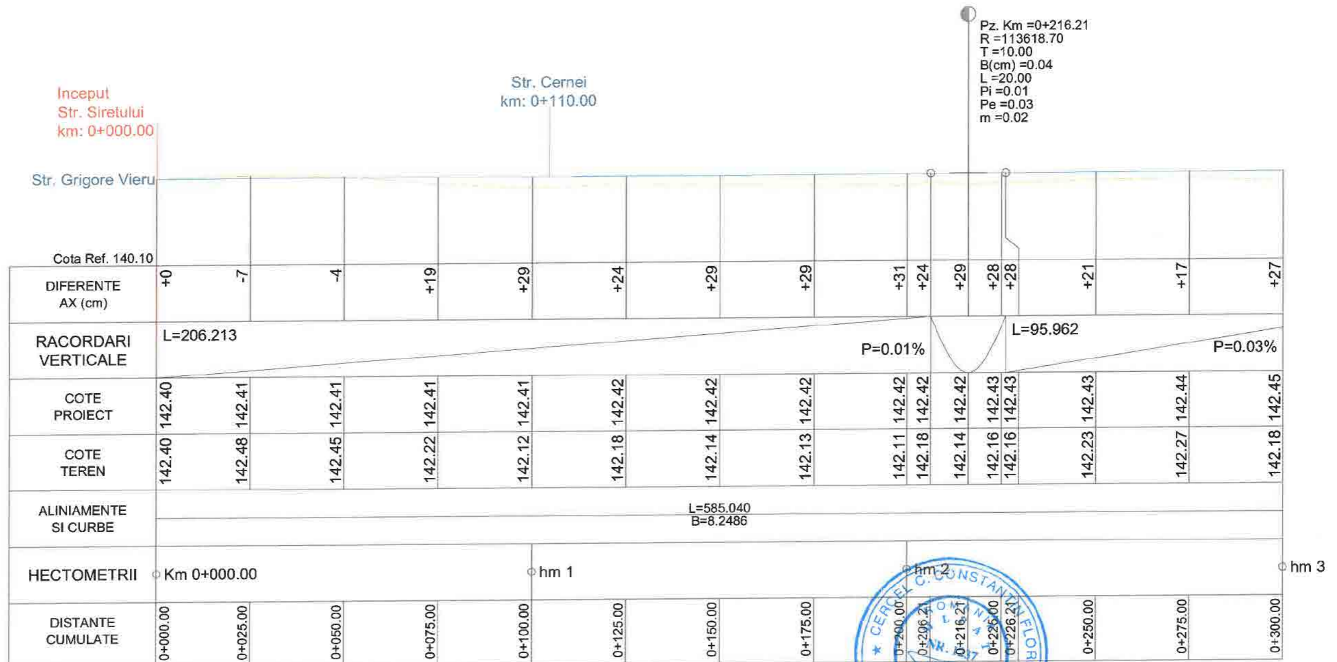
PROFIL LONGITUDINAL Str.Siretului DE LA 0.000 LA 300.000 SCARA : ORIZ 1 :1000 VERT 1 :100
